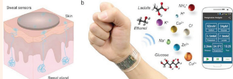
رسم توضيحي لعمل أجهزة استشعار العرق من الغدد العرقية لتحليل مكونات العرق البيولوجية
