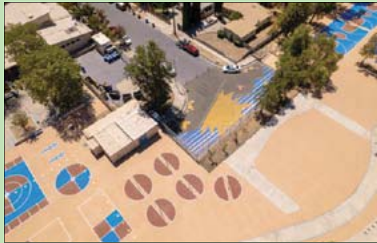
يُستخدم الطلاء مع إضافات تعكس ضوء الأشعة تحت الحمراء
