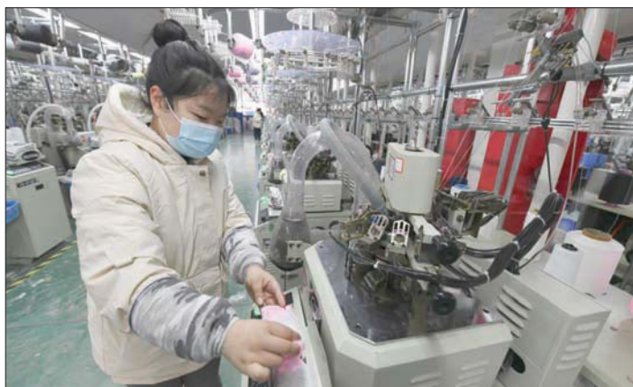
عاملة تشغل آلة لحياكة الجوارب في مصنع بمقاطعة فونان بوسط الصين (آب)
