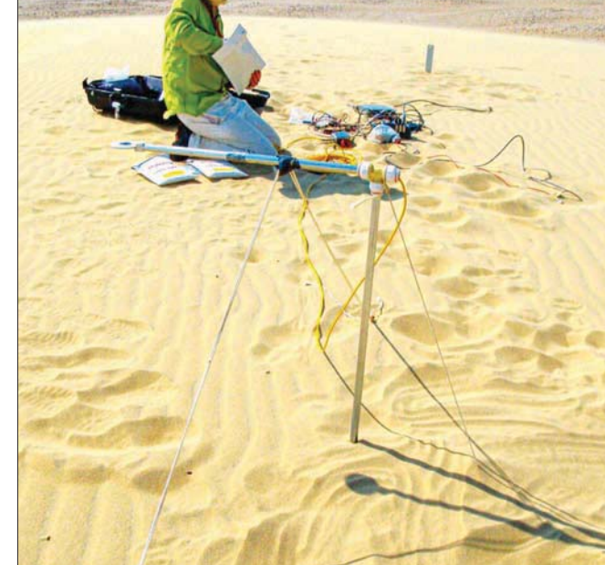
ميشيل لوج يستخدم مجسات السعة في صحراء قطر لدراسة الكثبان الرملية
