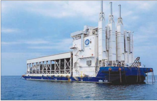
تعتمد محطة تحلية المياه العائمة ذاتية توليد الكهرباء، على تقنيات متقدمة لتصفية ومعالجة مياه البحر (واس)
