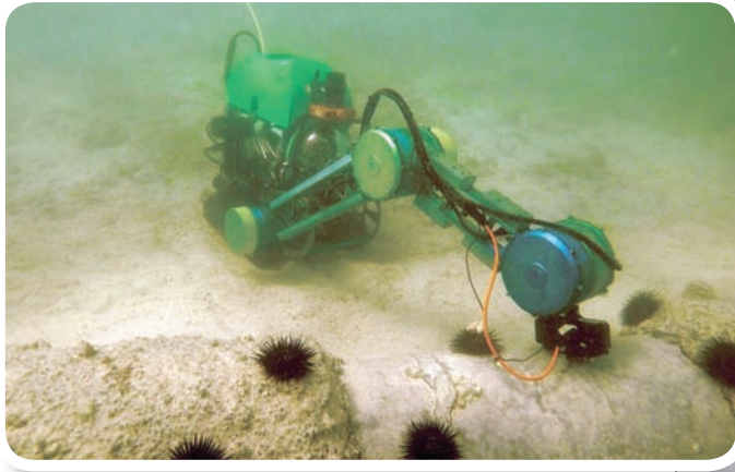
روبوت الفحص والمراقبة في المياه الضحلة أثناء تجربة ميدانية في الرصيف الغربي لميناء رأس تنورة
