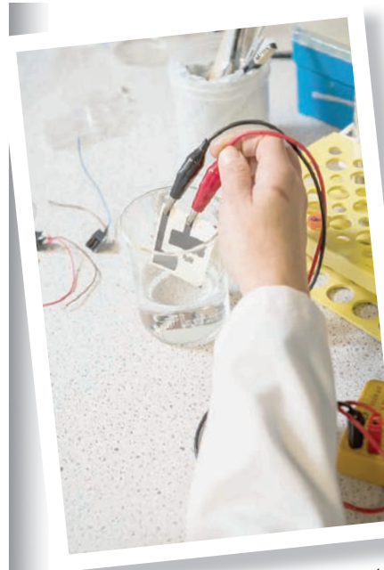
المجس الورقي الرقيق لكشف الملوثات (صورة من جامعة بات)
