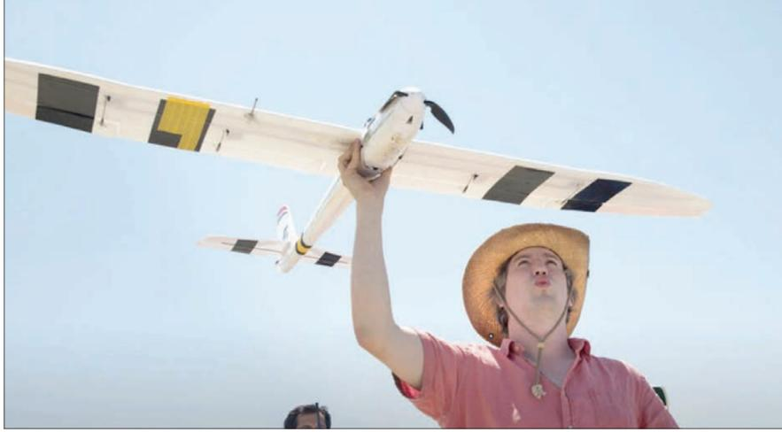
بمجرد تحليق الطائرة تستخدم الذكاء الاصطناعي حتى تعثر على مصادر حرارة أو فقاعات هوائية حتى تظل محلقة في الجو (نيويورك تايمز)
